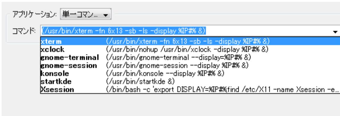
最後の手順では、このセッションを実行するときどの X サーバを使用し、どのクライアント（複数可）を起動するかを指定するセッション定義を作成します。この例では、クライアントアプリケーションを閉じるとセッションが自動的に停止するようにも構成します。
